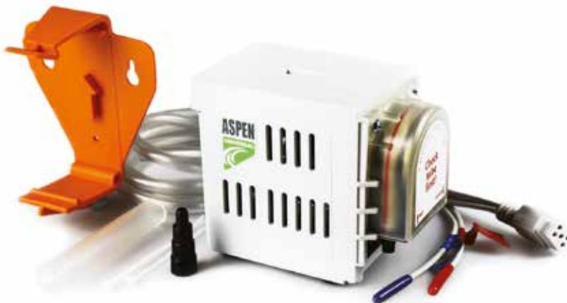
La pompa Universal più venduta è attivata da due sensori di temperatura dell'aria. Il movimento rotatorio della pompa peristaltica genera una pressione continua che consente di posizionare la pompa a 8 m di distanza dalla sorgente senza alcuna ripercussione sulle prestazioni.
