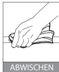
Behälter vor Gebrauch gut schütteln. EasyFind® gleichmäßig auf verdächtige Verbindungsstellen oder Komponenten sprühen. Große Lecks bilden sofort Blasen; langsame, kleine Lecks bilden innerhalb von wenigen Sekunden oder gar erst Minuten Blasen. Nach abgeschlossener Lecksuche die untersuchten Stellen mit einem feuchten Tuch abwischen.
