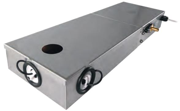
Aus robustem Edelstahl gefertigt, ist diese Pumpe extrem einfach zu installieren und zu warten. Die Pumpe ist so konstruiert, dass sie mittels Bypass Strömung das Wasser in der Kondensatwanne in Bewegung hält und so die Möglichkeit der Ansiedlung von Biofilm reduziert. Sie wird direkt unter den Kühlmöbeln des Einzelhandels platziert und entfernt das Kondensat während des Abtauzykluses.
