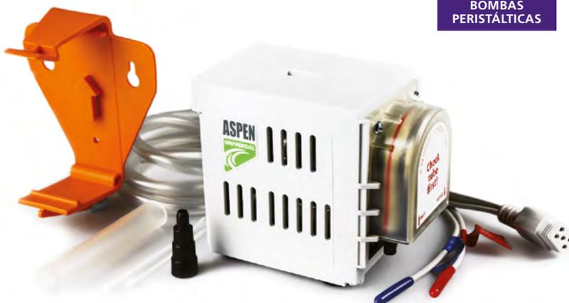
La éxito de ventas Universal es operada por dos sensores de temperatura del aire. El movimiento giratorio peristáltico crea una presión continua, lo cuál significa que la bomba puede ser colocada a muy lejos de la fuente sin ningún efecto en el rendimiento.
