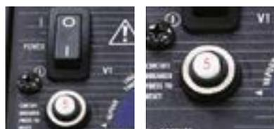
Interruptor de encendido, cableado y disyuntor libre de chispas integrados
