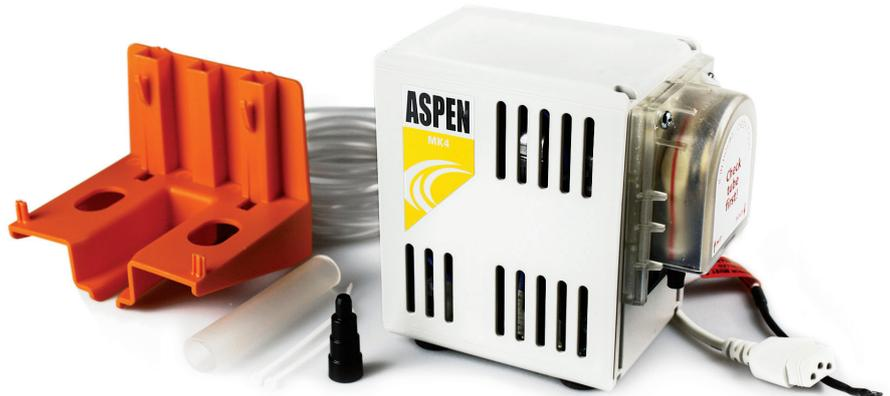
La peristáltica MK4 es operada usando dos sensores de agua. El sensor inferior entra en contacto con el agua y la conductividad térmica desde ese sensor proporciona una diferencia de temperatura entre el segundo, energizando la bomba.
