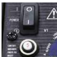
Interruptor de encendido, cableado y disyuntor libre de chispas integrados
