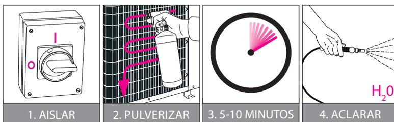
Aísle los componentes eléctricos. Pulverice sobre el serpentín, comenzando en la esquina superior izquierda, cubriendo, de forma metódica, toda su anchura y altura. Aclare minuciosamente con agua limpia después de su uso.
