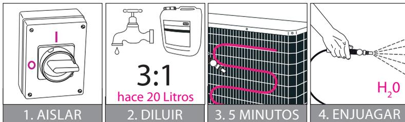
Para usar SuperClean™ como un limpiador extrafuerte y espumoso para condensadores de aletas de aluminio enfriados por aire, diluya en 3 partes de agua. Use un spray de baja presión para rociar entre las aletas.
