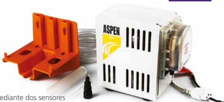
MK4, la bomba peristáltica que se activa mediante dos sensores de nivel de agua. Cuando el sensor inferior entra en contacto con el agua, la conductividad de calor de dicho sensor produce un diferencial de temperatura con el segundo, lo que activa la bomba.
