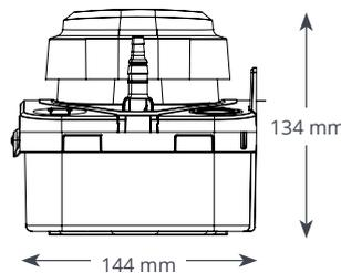
Le clapet anti-retour a une ouverture de 6 mm en standard, qui peut être coupée à 10 mm pour améliorer le débit d'eau.
