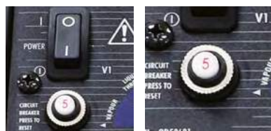
Beveiligde schakelaars & stroomonderbreker
