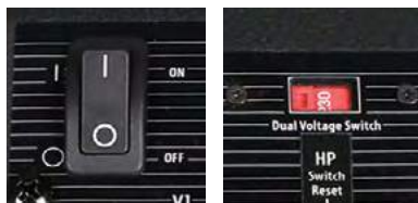
Beveiligde schakelaars & stroomonderbreker
