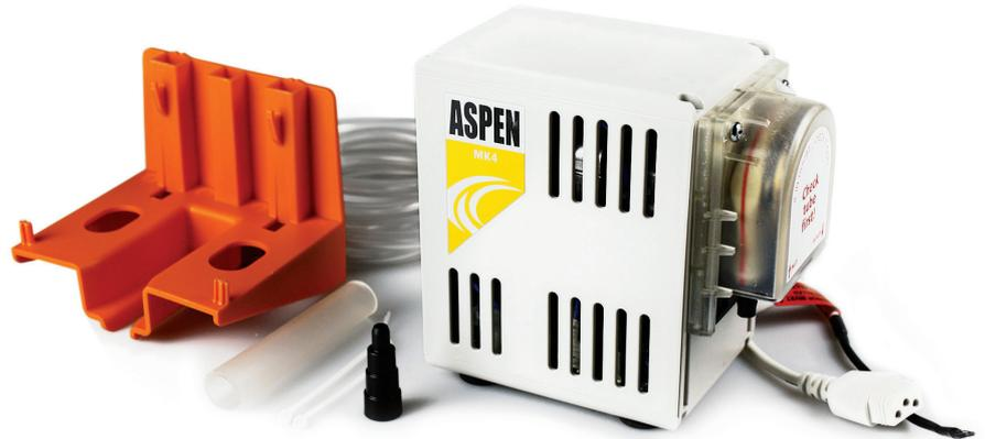
A peristáltica MK4 é comandada usando dois sensores de água. O sensor inferior entra em contacto com a água, a condutividade do calor desse sensor proporciona uma diferença de temperatura entre o segundo - alimentando a bomba.
