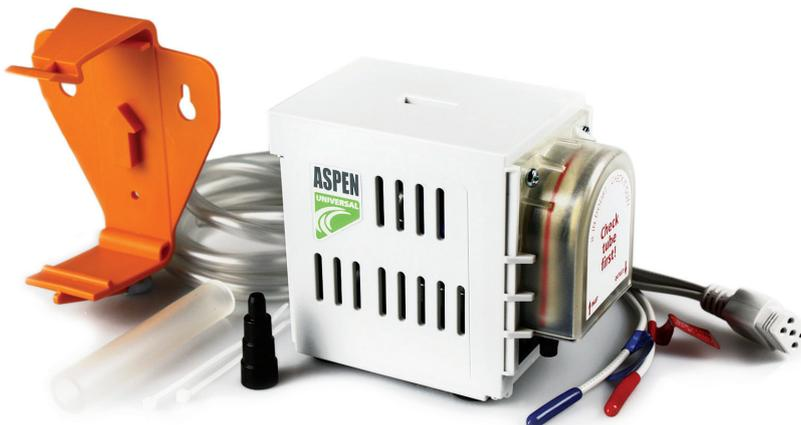
Один из самых продаваемых перистальтических насосов – насос модели Universal – управляется двумя датчиками температуры. Перистальтическое вращательное движение создает постоянную силу тяги, которая позволяет размещать насос на расстоянии до 3 м от источника конденсата без снижения его производительности.
